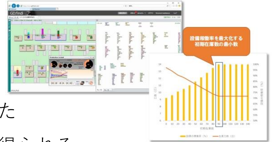
初期在庫数が及ぼす生産工数と設備稼働率の関係の例
