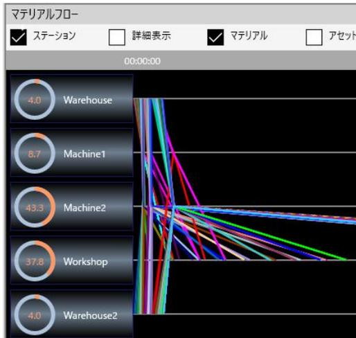
マテリアルフローを選択すると、フロアプランおよびプロセスプラン上の製品の流れを表示させることができます。
